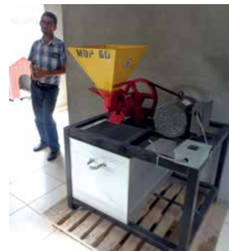
La máquina de descascarillado separa la cáscara del café, para aislar los granos y así poder trabajar con eficacia y mejorar la calidad.
