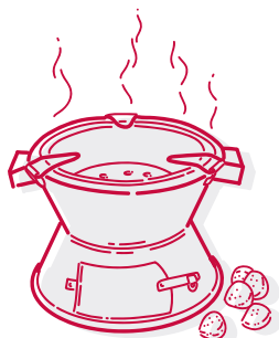
Foyer amélioré Jambar, fonctionnant au biocharbon, composé à 90% de résidus de production de charbon de bois et à 10% de typha, plante invasive locale.
